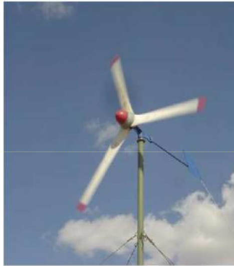
Turbina eolica ad eliche di 1 kW (0,001MW)
